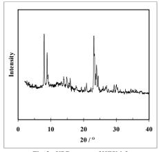
Fig. 2 : XRD pattern of HZSM-5.
